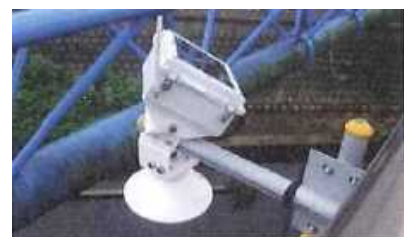
低コスト型水位計の設置例
