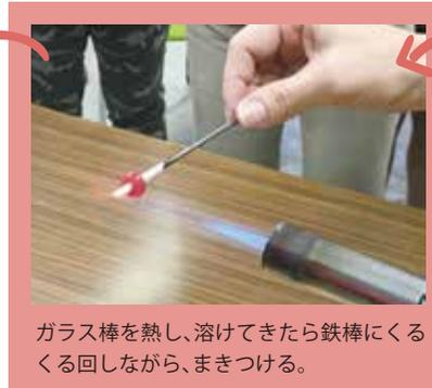
ガラス棒を熱し、溶けてきたら鉄棒にくるくる回しながら、まきつける。
