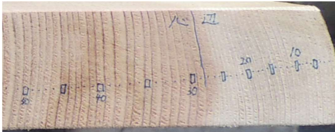
写真1 木口のマーキング状況
