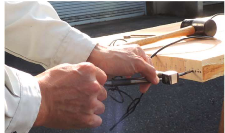
写真2 SPT計測状況
