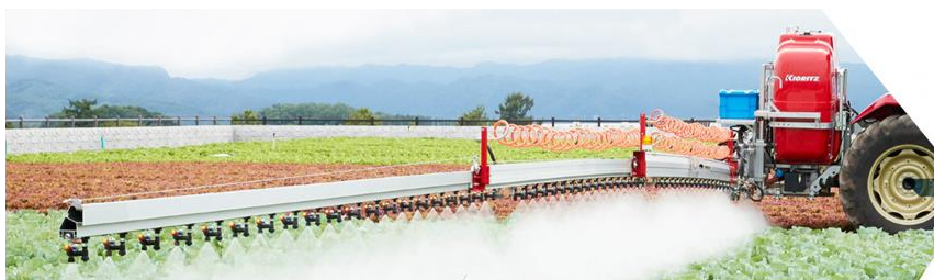
ブームスプレーヤによる農薬散布の様子
