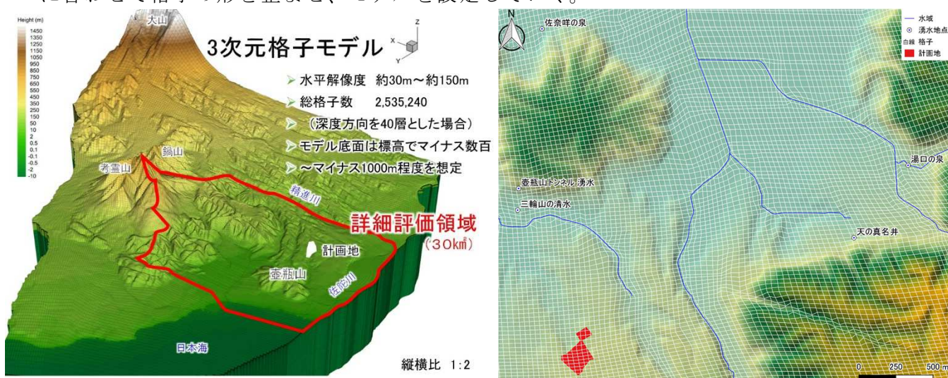
図2 三次元格子モデル(左: 全域、右: 拡大図)
