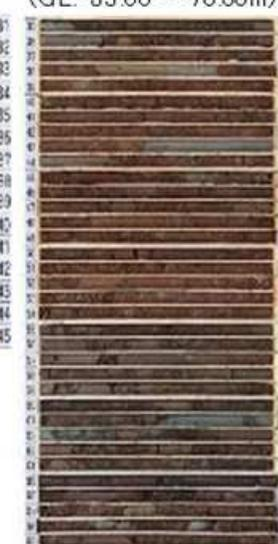
安山岩質火砕岩(自破碎岩)で、マトリックスや大半の岩片は高温酸化により赤色～赤褐色を呈する。含まれる岩塊はマトリックスと同質の岩片だが、すべて緻密で堅硬な安山岩質溶岩。まれに青灰色の非酸化岩片が混入。マトリックスは粗粒な火山砂～小礫で、隙間が多く、地層全体としては高透水性。
