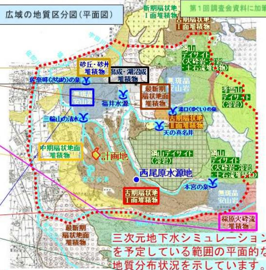
三次元地下水シミュレーションを予定している範囲の平面的な地質分布状況を示しています。
