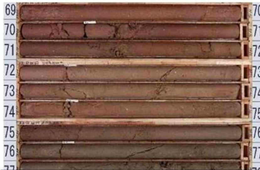
写真③：ボーリングコア写真 (KR02-No.9-1:GL-65.10～78.50m)
