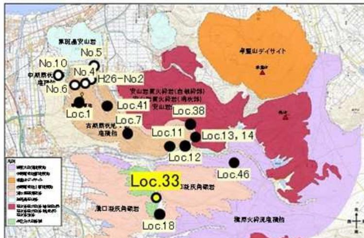
図中○地点でのボーリング調査、●地点で多数の露頭を確認。同質の地層を確認。
