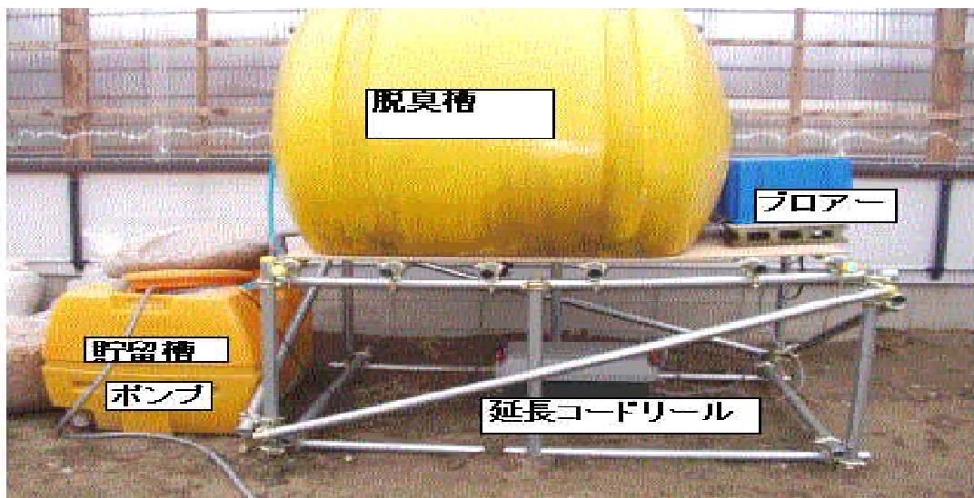
図2 ガラス発泡材脱臭装置の設置状況
