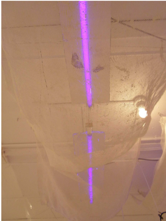
写真2 光触媒担持ネットとブラックライト
