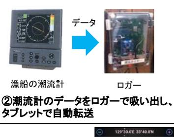
②潮流計のデータをロガーで吸い出し、タブレットで自動転送
