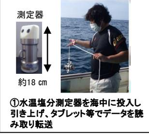
①水温塩分測定器を海中に投入し引き上げ、タブレット等でデータを読み取り転送
