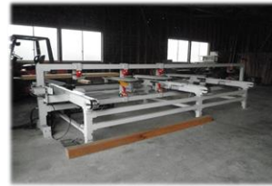
グレーディングマシン (強度等を調べる測定器)
