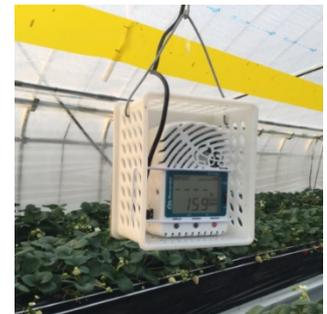
写真5 代替えの炭酸ガス測定器
