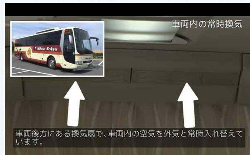
約5分で車両内の空気を外気と常時入れ替えています。
