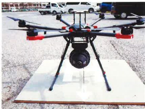
写真-1 MATRICE600 最大飛行時重量 15.5kg 最大ペイロード 6.0kg
