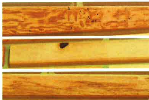
図2 虫穴（上）、節（中）、腐朽による変色（下）の例
