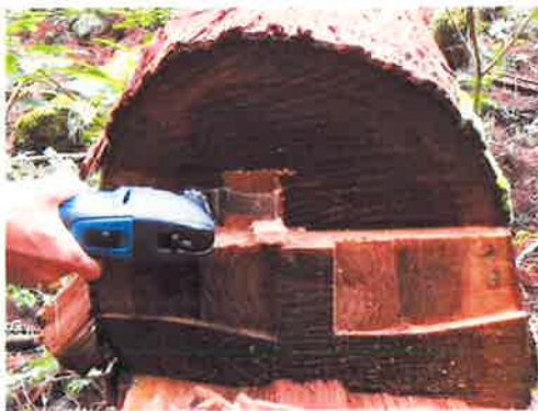
図1 木口の切り直し状況
