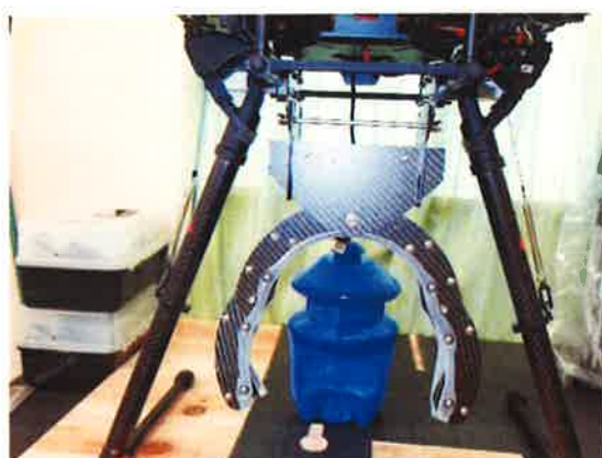
写真-2 試作した架台とレーザーのモックアップ 架台重量 + レーザーの重量 = 3.9kg
