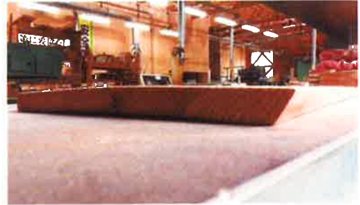
図1 幅反りしたスギ幅広板
