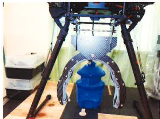
写真-2 試作した架台とレーザーのモックアップ 架台重量 + レーザーの重量 = 3.9kg
