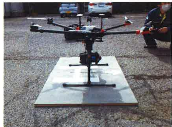
写真-4 レーザーは機体中央に取付
