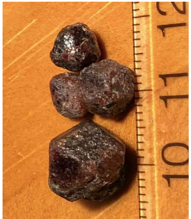
写真1 鉄を含むざくろ石の外観 （スケールの目盛は1mm）
