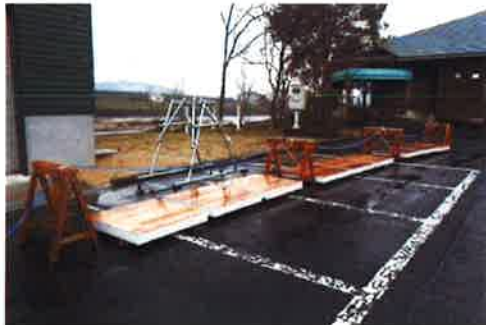
図1 試験体への散水状況
