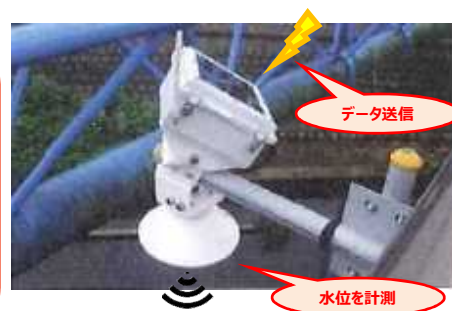
危機管理型水位計の設置例
