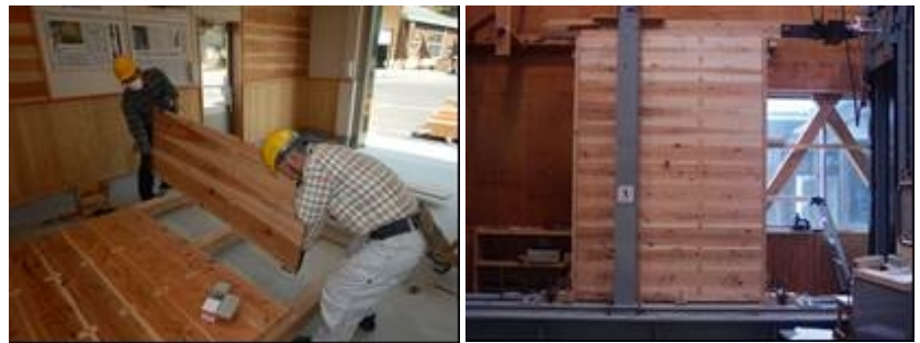
図-2 壁試験体の製作状況と実大壁試験
