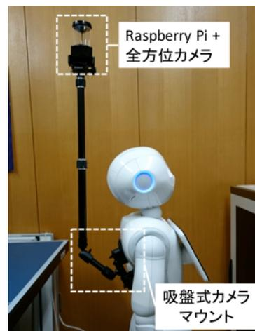
Fig.11 Pepperへの全方位カメラの取付け
