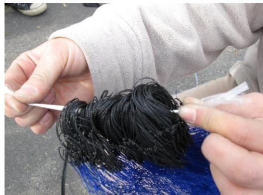
写真13 網の端を束ねたひもを抜き取らずにほどき、張り糸を通す
