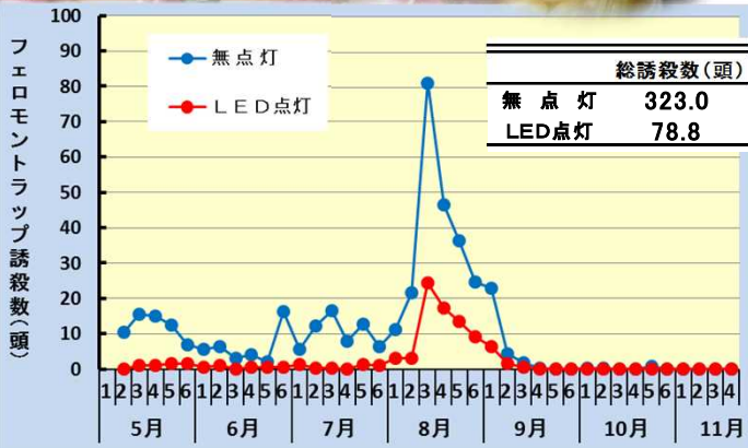
緑色LED灯の点灯がアワノメイガ誘殺に及ぼす影響(農業試験場ショウガほ場2014～2017)
