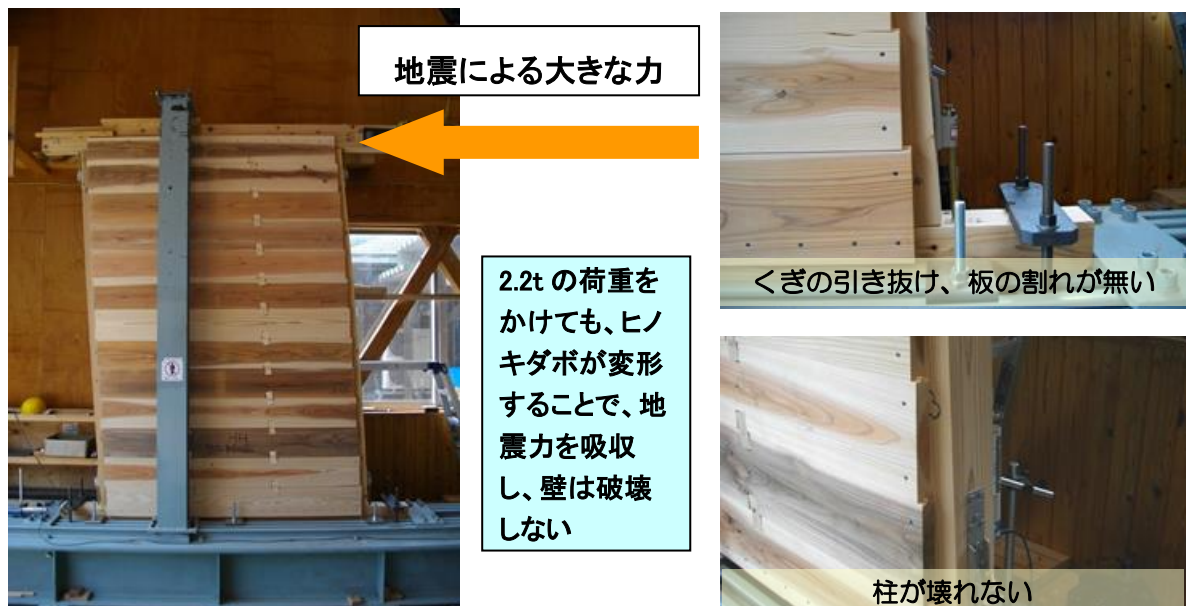
図4 実大壁試験による耐力壁の変形
