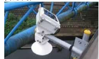
低コストな水位計の設置例
