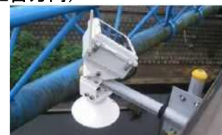
低コストな水位計の設置例
