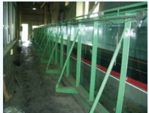
浜崖後退抑止工の水理模型実験状況
