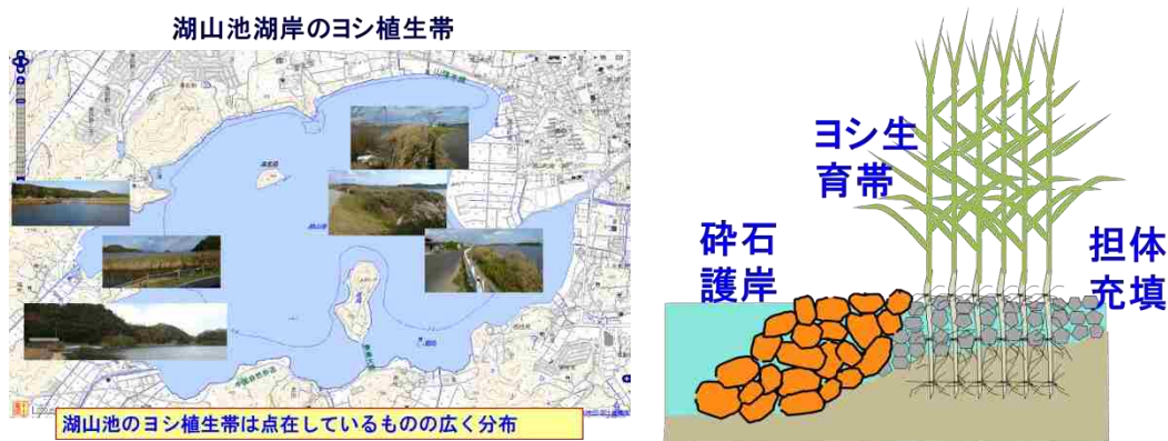
図 7-1 湖山池湖岸のヨシ植生帯とヨシと担体を組み合わせた水質浄化護岸の設置例
