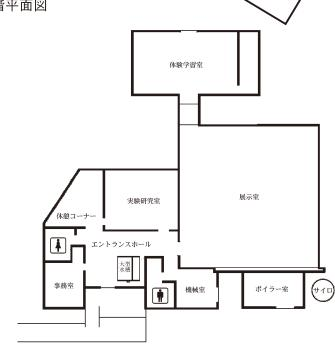
展 室  $218 \text{m}^2$ 示 体験学習室  $77\,\text{m}^2$ 実 験 研 究 室  $48\,\text{m}^3$ 事  $22\, {\vec{m}}$ 務 休憩コーナー 28 m² 機 械 18m² ボイラー室  $24 \, \text{m}^{^2}$ ト イ レ (2)  $24 \text{m}^2$
