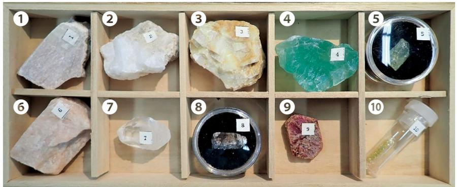
写真1. モースの硬度計(10種の基準鉱物) 個人蔵
