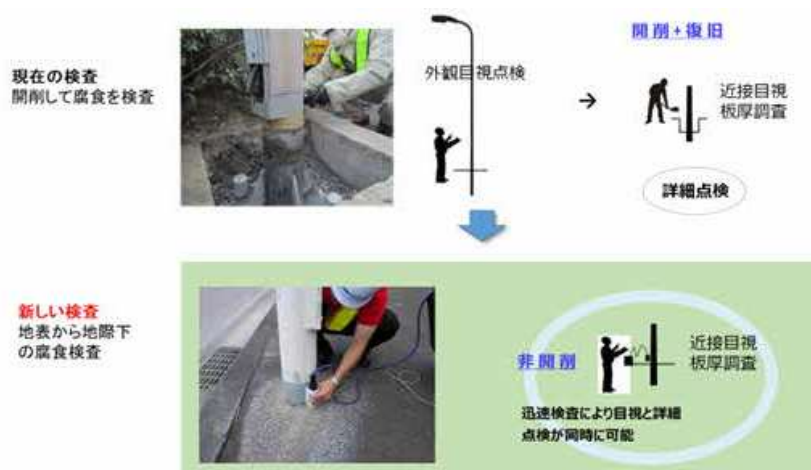
鋼板腐食検査器を使用した調査
