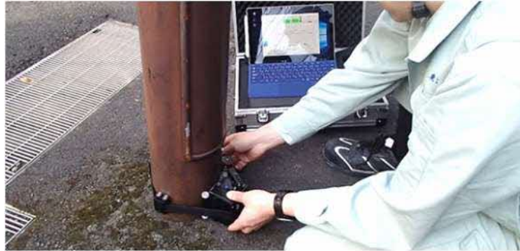
埋設部腐食検査装置を使用した調査
