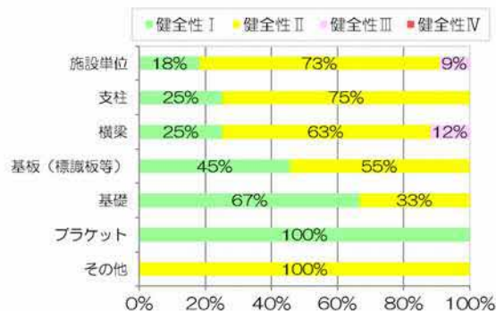
図 6.4 部材別の健全性評価結果（道路情報提供装置）
