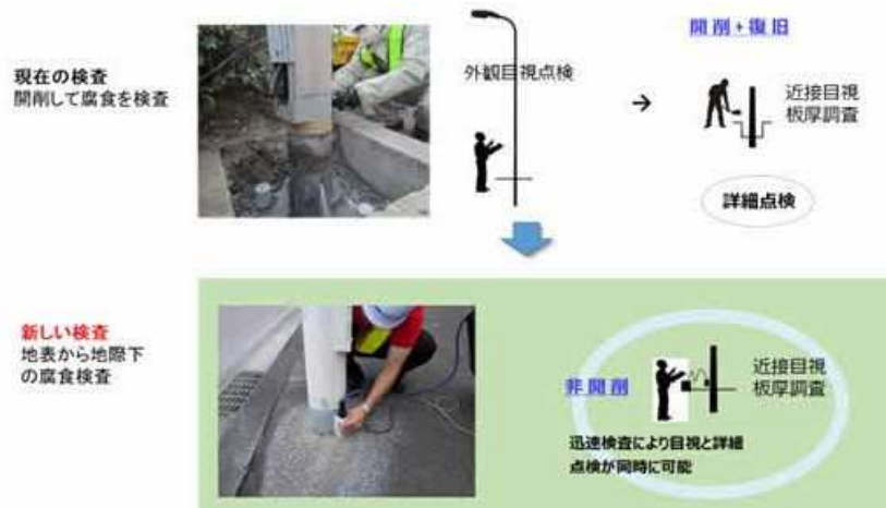
鋼板腐食検査器を使用した調査
