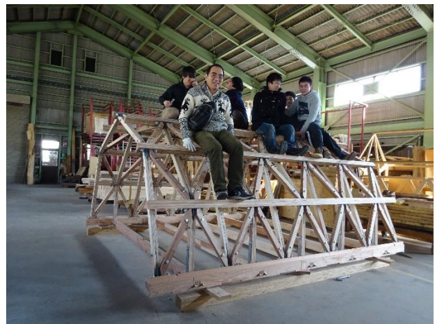
写真2 完成後の3mスパンヴォールト構造
