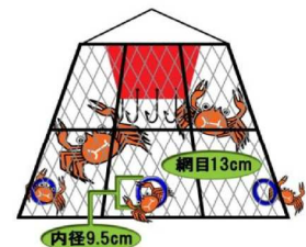
籠には脱出口を設け、小型のカニを逃がしている。
