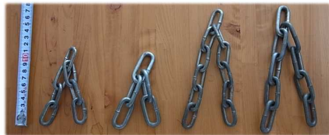
短・細 約6.5kg 短・太 約7kg 長・細 約10kg 長・太 約12.5kg
