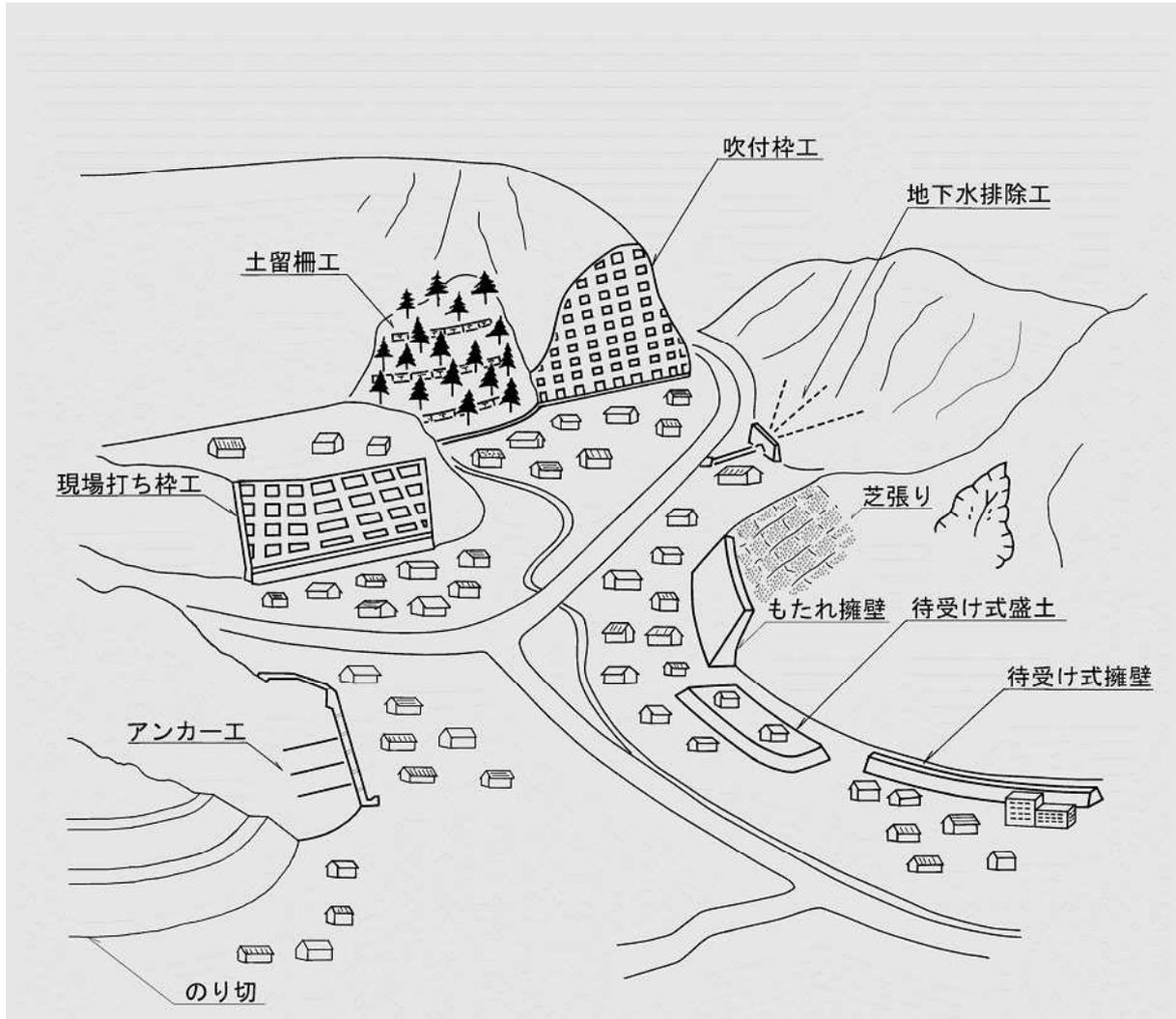
図 2-8 急傾斜地の崩壊に関する対策施設のイメージ
