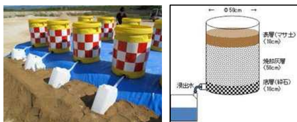
図 1 ライシメータの様子と構造
