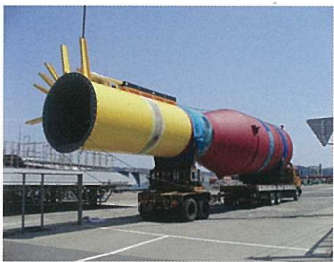
3. 鋼製の上部浮体部は、風車の組立岸壁近くの工場で製造しました。
