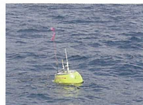
ブイ式波浪計で風車設置地点の波浪(波高、周期、波向)を連続的に観測しました。
