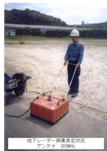
写真1 地下レーダー探査測定状況
