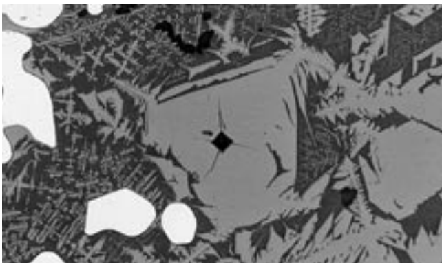
写真14 鍛造剥片・含鉄鉄滓の顕微鏡組織
