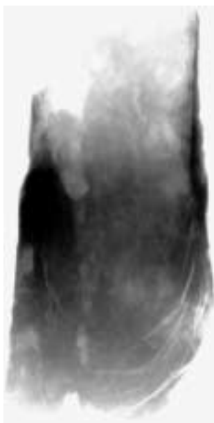
第21図 青谷上寺地遺跡から出土した鉄斧のX線ラジオグラフ
