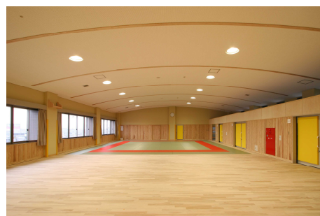
鳥取警察署道場: 内壁に木の準不燃材料を使用
