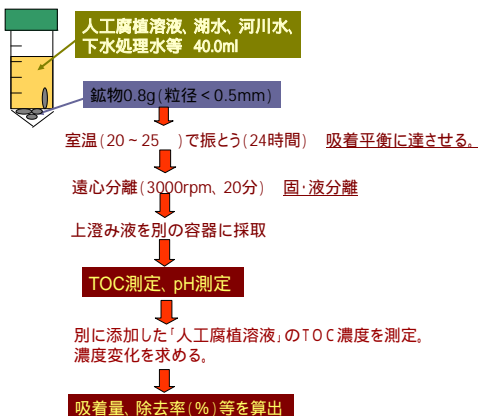
図2-4 バッチ式吸着試験
