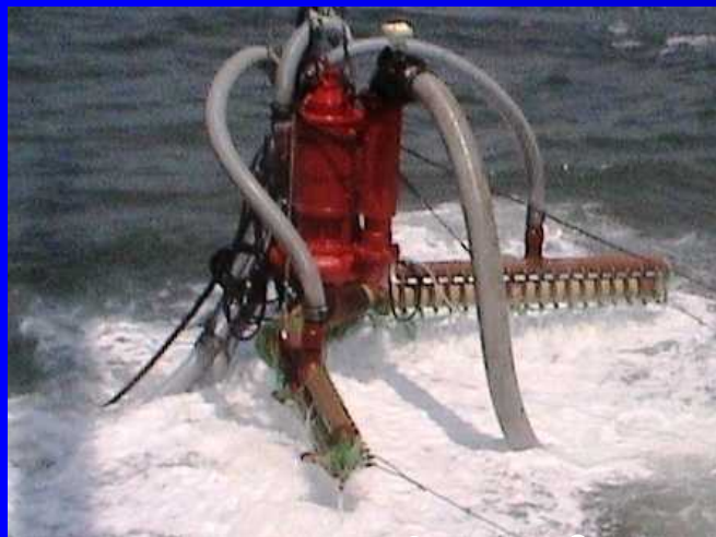
水ジェットポンプ3台
