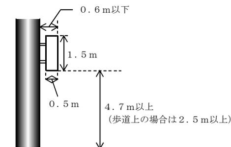
【図8-2】電柱に巻き付ける場合
