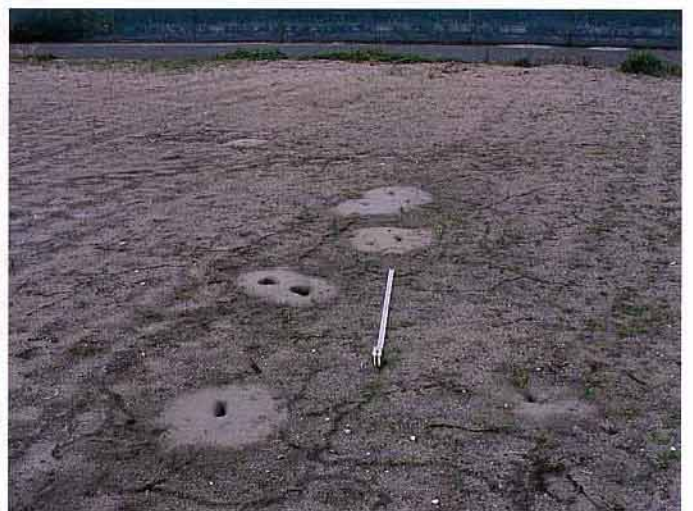
写真17 境港市幸神町，砂丘と砂洲の間の低地に客土した畑に生じた噴砂，ここの地下水位は約30cmと極めて浅い，埋立地に比べて噴砂の規模も頻度も小さい。
