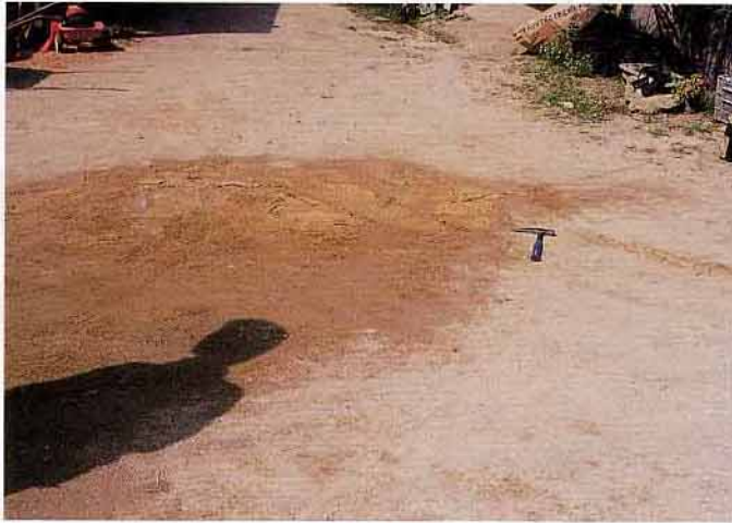
写真26 住宅横で発生した噴沙跡、伯太町上小竹、安野宅、N75E方向で最大幅約3cm、泥水の噴出は高さ約30cmに達した。
