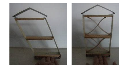
紙でできた家の模型で筋かいの効き目を実感できます
