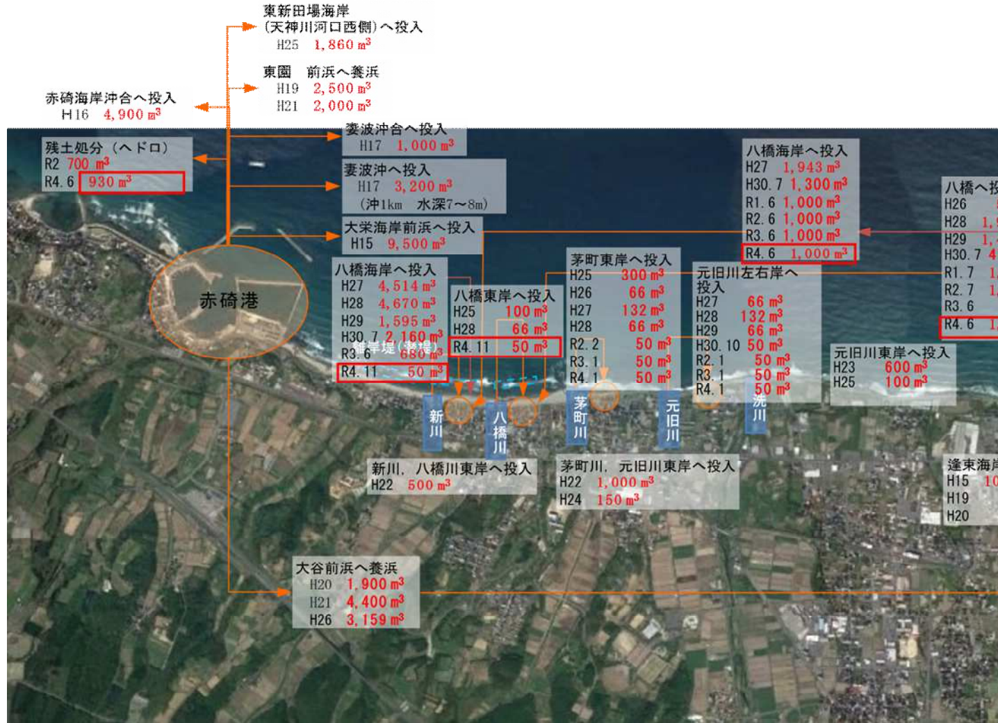
中部沿岸における土砂投入状況(土砂投入箇所)
