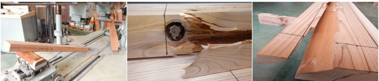
図 4 中央から破断した試験体
