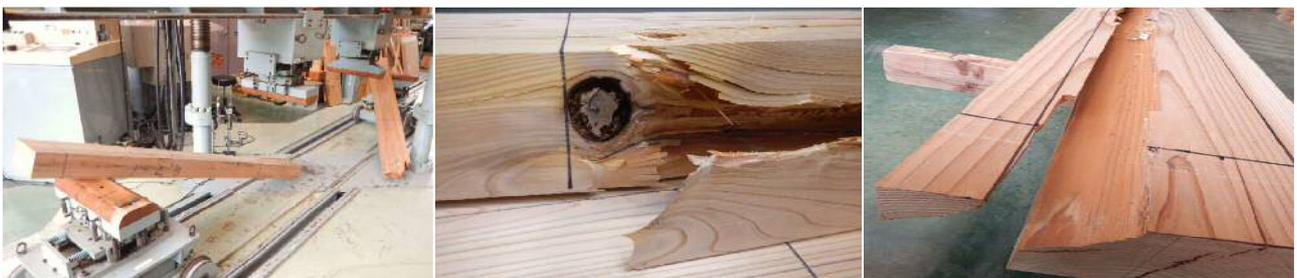
図 4 中央から破断した試験体
