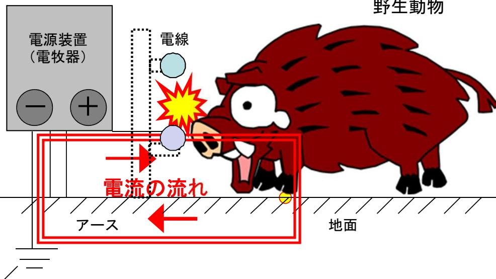
■電気柵は、野生動物が電線に触れたときに電気ショックを与えて痛み学習させる心理柵。電気を通しやすい鼻や口をいかに電線に触れさせるかが重要です。
